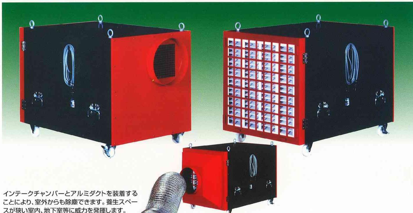
インテークチャンバーとアルミダクトを装着することにより、室外からも除塵できます。養生スペースが狭い室内、地下室等に威力を発揮します。
