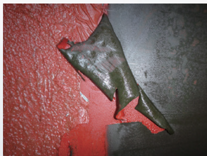
はく離除去した塗膜の状態 ≡ 湿潤シート状態
